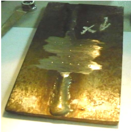
Рисунок 5 – Загальний вигляд дослідженого фрагмент будівельної зварної конструкції
