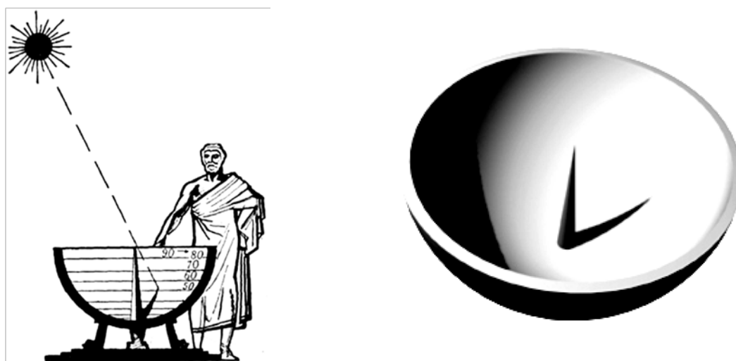
Рисунок 2 – Общий вид и принцип работы Скафиса
