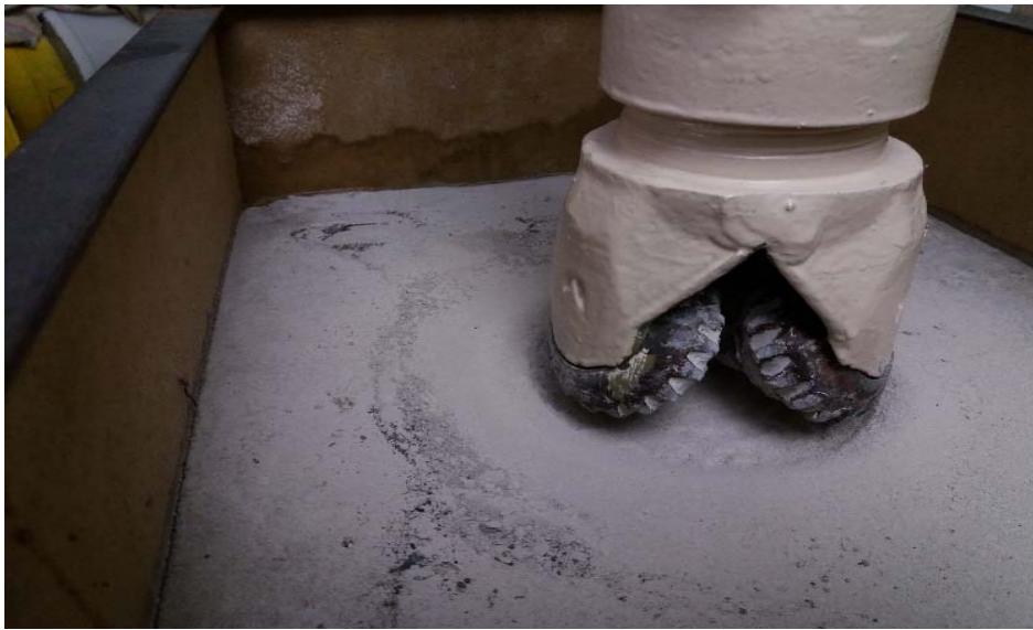
Рисунок 2 – Шарошкове долото на тестовому стенді Данні отримані в результаті обробки відео заносились до таблиці Excel
