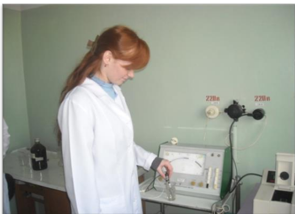
Рисунок 1 – Визначення рН води методом електрометрії.
