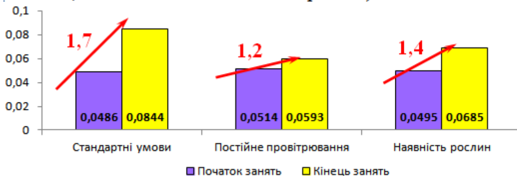
Рисунок 1 - Концентрація вуглекислого газу в повітрі класу при різних умовах стабілізації повітря
