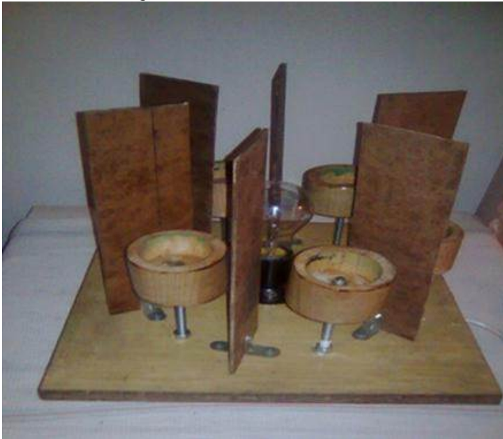
Рисунок 1 – Прилад для вивчення теплоізоляційних властивостей
