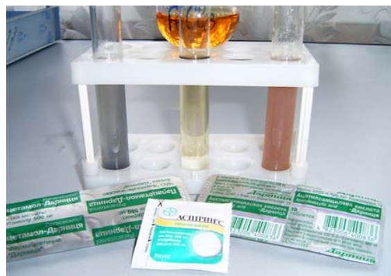
Рисунок 2 – Якісна реакція на фенол (фіолетове забарвлення в пробірці зліва)
