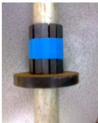
Рисунок 1 –Алюмінієва трубка оточена постійними магнітами
