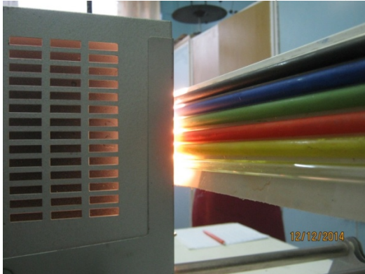
Рисунок 3 - Пристрій для дослідження температури повітря у трубці, в залежності від кольору покриття та графік
