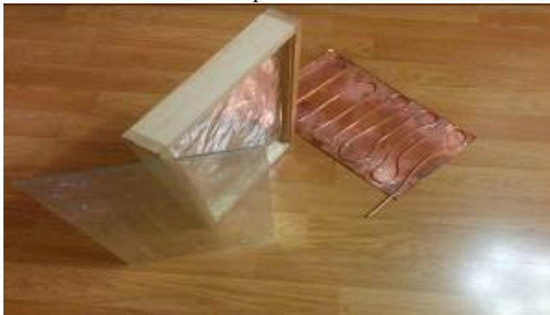
Рисунок 1 – Сонячний колектор, який виготовлено власноруч
