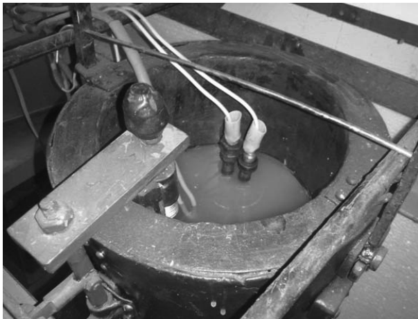
Рисунок 8 – Процес розплавлення парафіну в сталерозливному ковші
