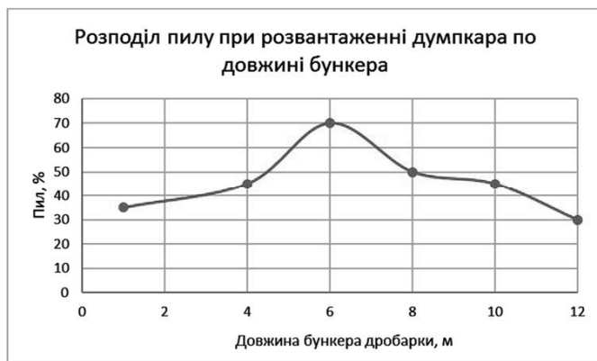
Рисунок 7 – Графік розподілу пилу при розвантаженні по довжині бункера
