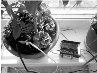
Рисунок 1 – Визначення вологості та температури ґрунту кімнатної рослини
