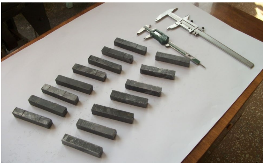
Рисунок 7 – Загальні види вихідних свинцевих зразків і вимірювального інструмента, використовуваних при лабораторних експериментальних дослідженнях умов реалізації процесу безкалібрової прокатки сортових заготовок
