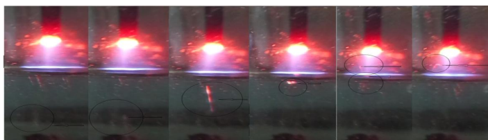
Рисунок 1.21 – Динаміка переносу заряджених бульбашок водню від металевго катода до металевго анода. Обробка розчину \text{CuSO}_4 (0,25 г/л) в дистильованій воді. Швидкість зйомки 20 кадрів в секунду
