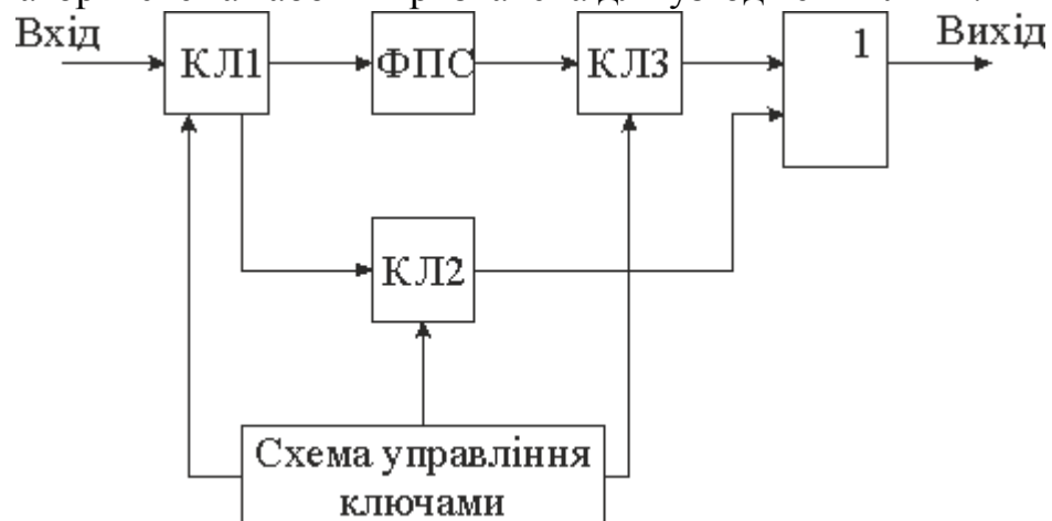
Рис.1 Структурна схема кодуючого пристрою
