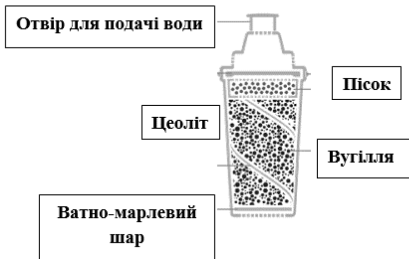
Рисунок 2.23 – Схема змінного картриджу фільтру
