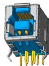
Рисунок 3 – Конструкція USB 3.0 типу B
